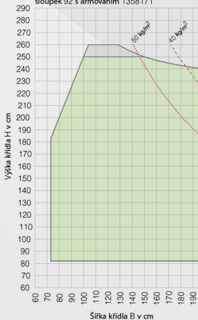
Křídlo s armováním 1358172, sloupek 92 s armováním 1358171
