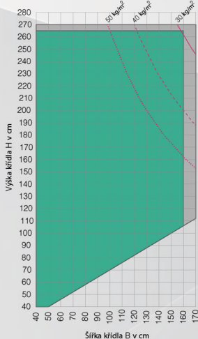
Křídlo s armováním 1358167 a REHAU vlepováním skel do křídlových rámu
