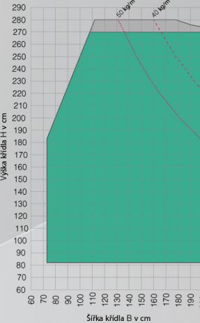
Křídlo s armováním 1358172 a velkou klapačkou s armováním 1358168, s REHAU vlepováním skel do křídlových rámu
