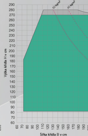
Křídlo s armováním 1358172 a velkou klapačkou s armováním 1358168, s REHAU vlepováním skel do křídlových rámu
