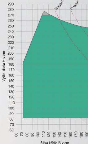
Křídlo s armováním 1358172, sloupek 92 s armováním 1358171, s REHAU vlepováním skel do křídlových rámu
