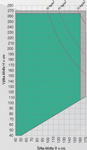
Křídlo s armováním 1358167 a REHAU vleповáním skel do křídlových rámu
