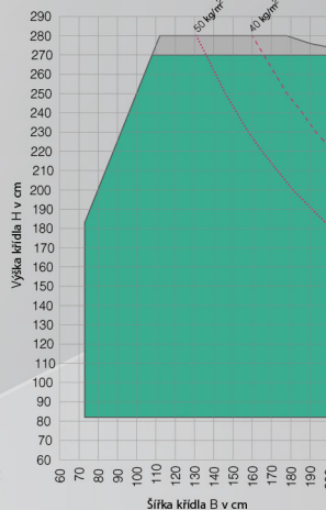
Křídlo s armováním 1358172 a velkou klapačkou s armováním 1358168, s REHAU vleповáním skel do křídlových rámu
