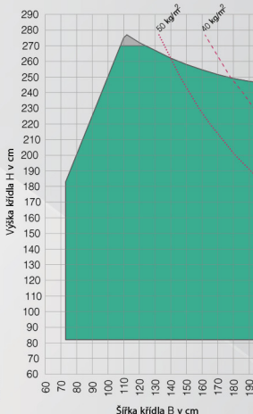
Křídlo s armováním 1358172, sloupek 92 s armováním 1358171, s REHAU vleповáním skel do křídlových rámu
