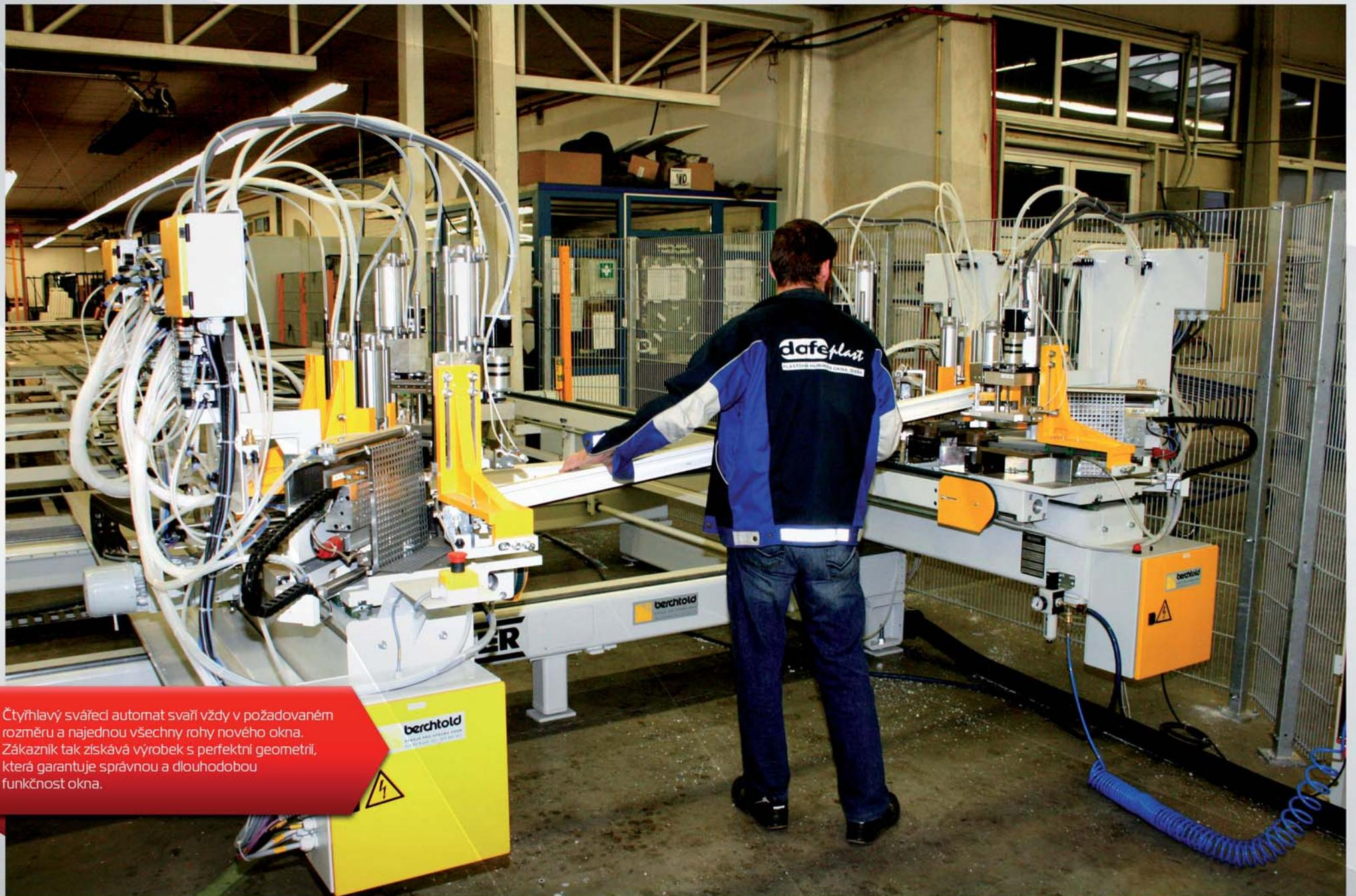
Čtyřhlavý svářecí automat svaří vždy v požadovaném rozměru a najednou všechny rohy nového okna. Zákazník tak získává výrobek s perfektní geometrií, která garantuje správnou a dlouhodobou funkčnost okna.
