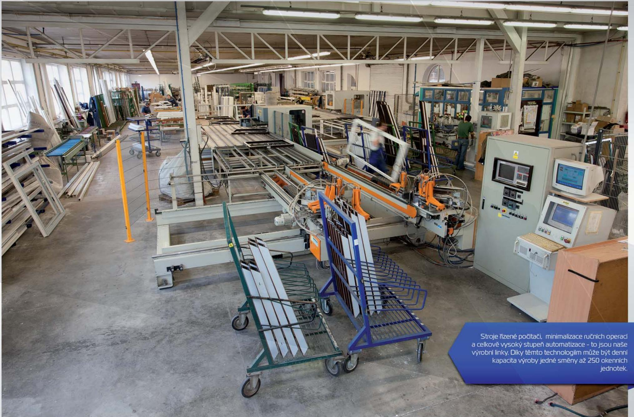
Stroje řízené počítači, minimalizace ručních operací a celkově vysoký stupeň automatizace - to jsou naše výrobní linky. Díky těmto technologiím může být denní kapacita výroby jedné směny až 250 okenních jednotek.
