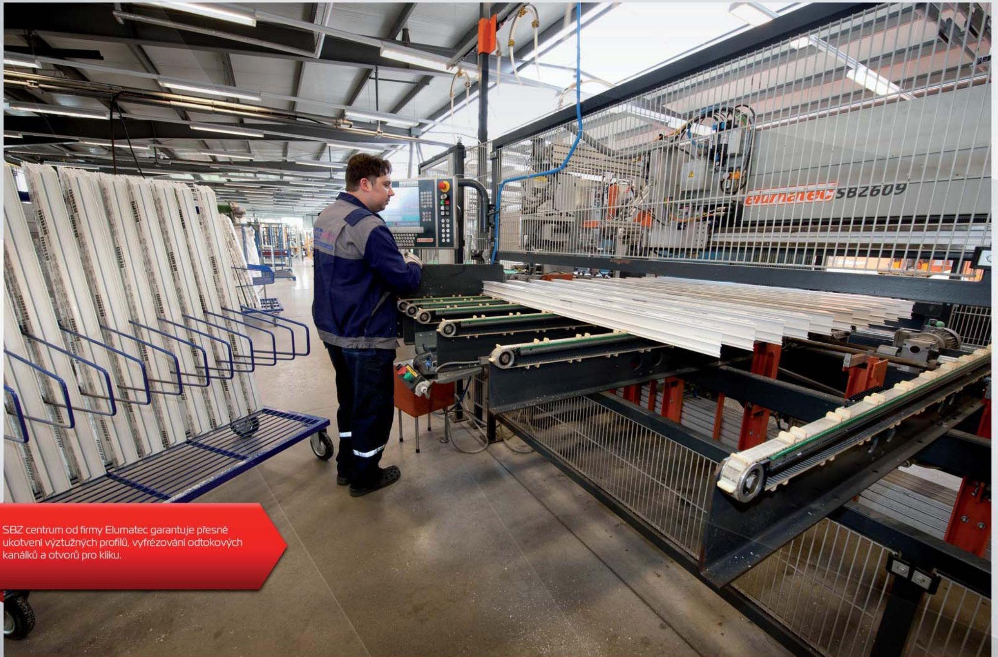
SBZ centrum od firmy Elumatec garantuje přesné ukotvení výztužních profilů, vyfrézování odtokových kanálků a otvorů pro kliku.
